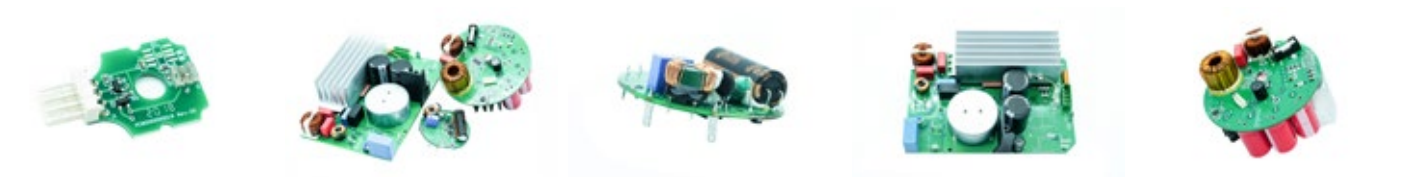
Progettazione HW e FW di schede elettroniche (per azionamenti motori brushless, encoder, etc.)
